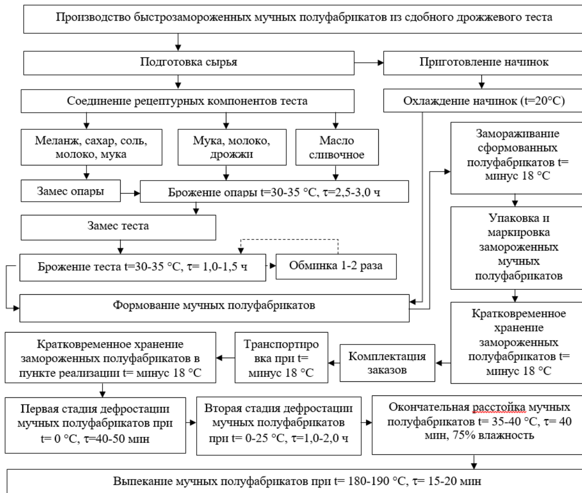
Рисунок 2. Комплексная технологическая схема мучных сдобных изделий по технологии «готовые к расстойке»
